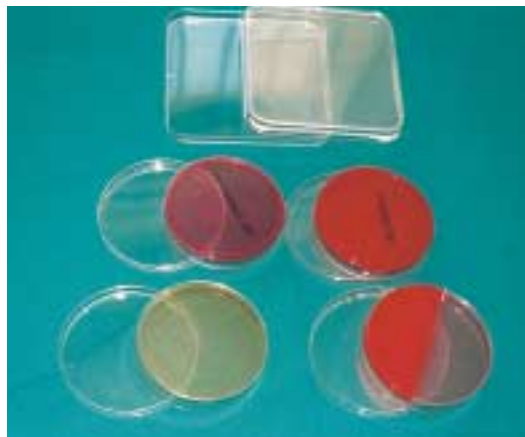
Εικόνα 5.1: Τρόπος στεγνώματος τρυβλίων πριν τη χρήση
